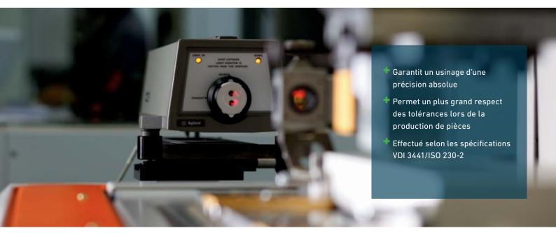
Au cours de ce service préventif, nos techniciens vérifient la précision et la répétabilité du positionnement linéaire des axes de vos machines de Fraisage, d'Electroérosion et de Laser GF Machining Solutions. Les déviations détectées sont corrigées en modifiant les tables de correction de l'axe selon les normes VDI 344/ISO 230-2. Dans les cas critiques, il peut être recommandé d'effectuer une intervention mécanique.
